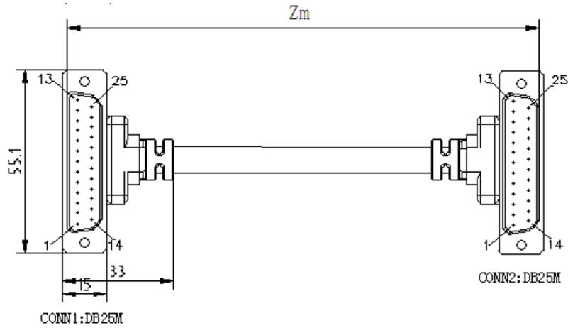
图AA. 9 ZGCHDB25M-A- $Z_m$ 连接器外形尺寸
