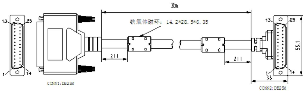
图AA. 10 ZGCHDB25M-B- $X_m$ 连接器外形尺寸
