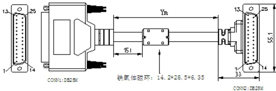
图AA. 11 ZGCHDB25M-B- $Y_m$ 连接器外形尺寸
