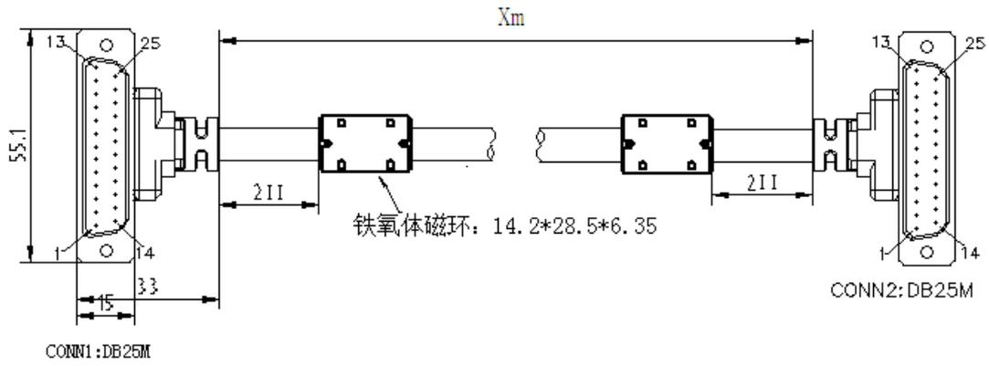
图AA. 8 ZGCHDB25M-A- $X_m$ 连接器外形尺寸
